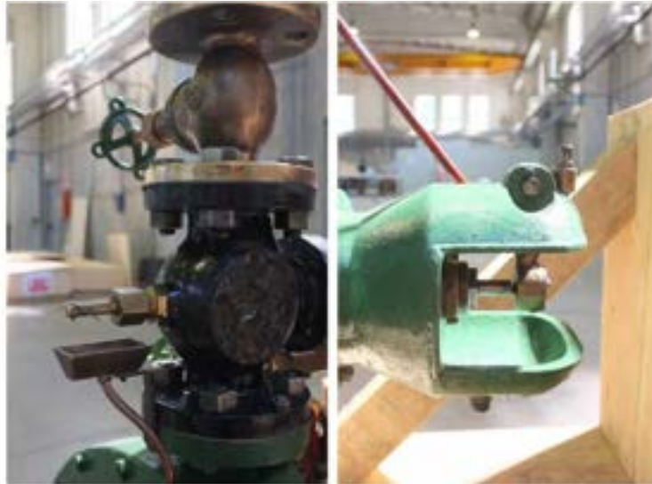
Figura 12: valvola controllata dal regolatore di giri, sinistra; punteria comando valvola di regolazione, destra.
