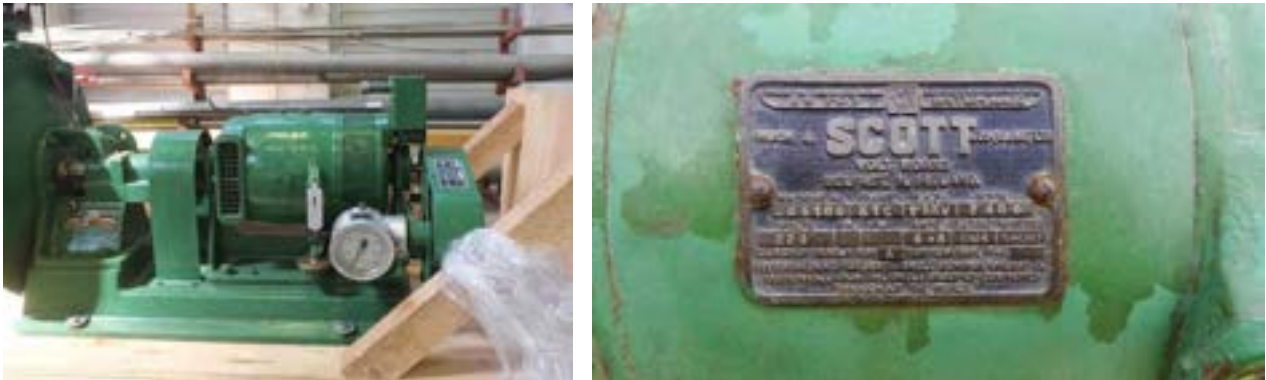
Figura 16: Turbogeneratore Sissons Ltd. - particolare del generatore elettrico, sinistra; targa del generatore elettrico 220 V CC, destra (prima della revisione)
