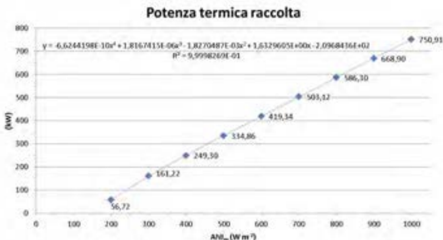
Figura 3-4 – Potenza termica raccolta nella linea di lunghezza 200 m
