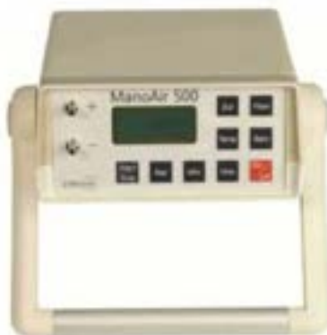
Figura 4-1 –Misuratore di pressione differenziale tra le sezioni di ingresso e uscita dell’aria
