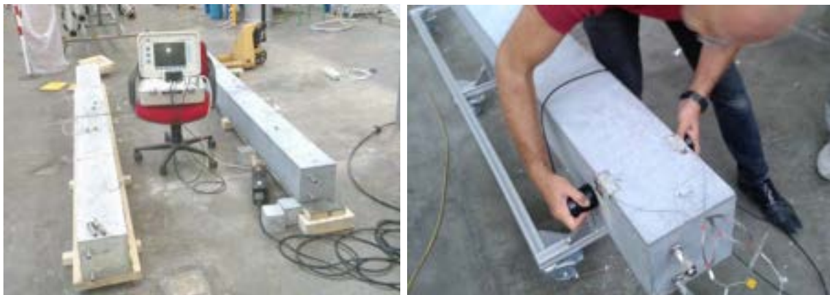
Figura 46: Misura delle caratteristiche meccaniche con tecnica ad ultrasuoni dopo lo scassero dei moduli e dopo ciclo di degasaggio.
