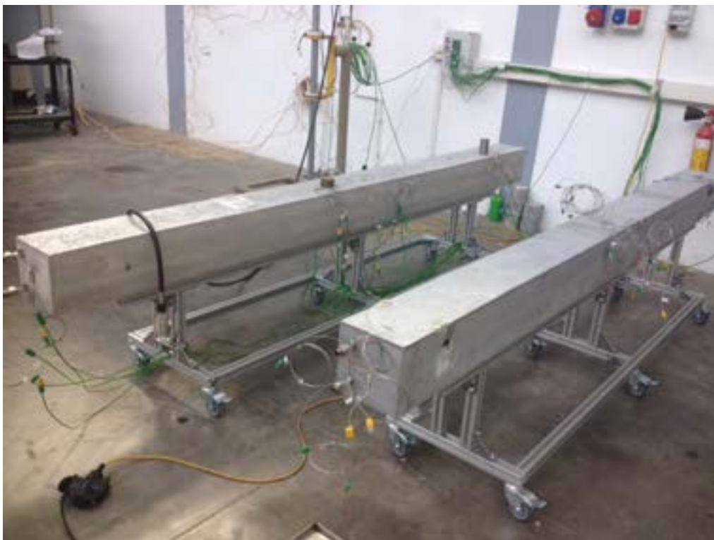
Figura 16: particolare del sistema di accumulo, nel quale si vedono i materiali cementizi utilizzati, il sistema di rilevazione della temperatura mediante termocoppie e le strutture di sostegno.
