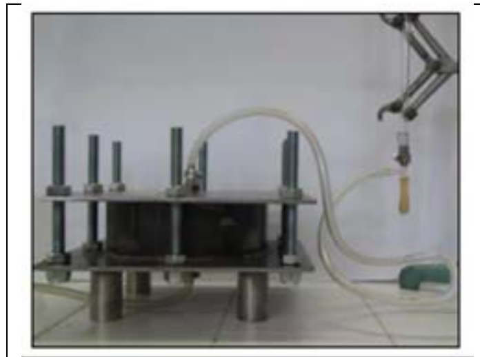
Figura 12 – Cella per la misurazione della permeabilità ai gas.
