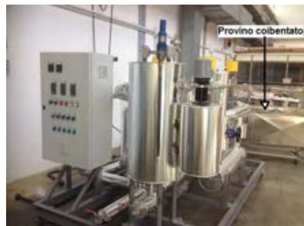
Fig. 13 Setup di prova prima della coibentazione del provino a); dopo la coibentazione b).
