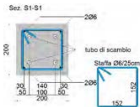
Fig. 4 Sezione trasversale dell'elemento strutturale.
