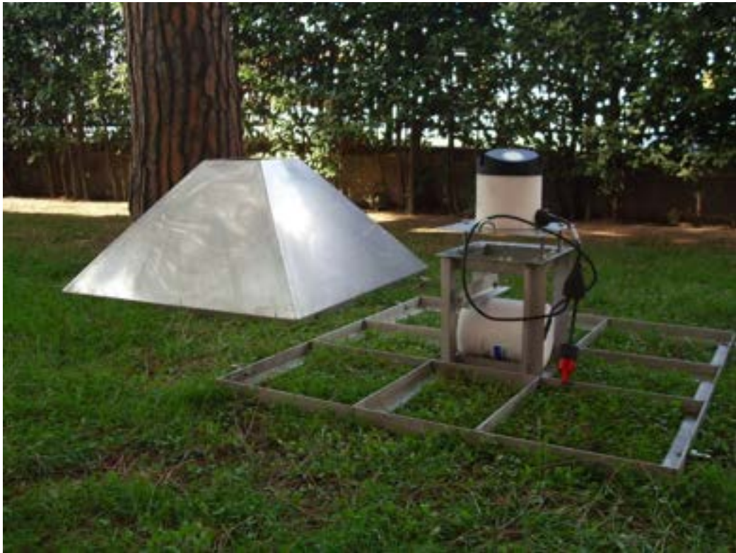
Struttura con Argonaut XR montato e copertura
