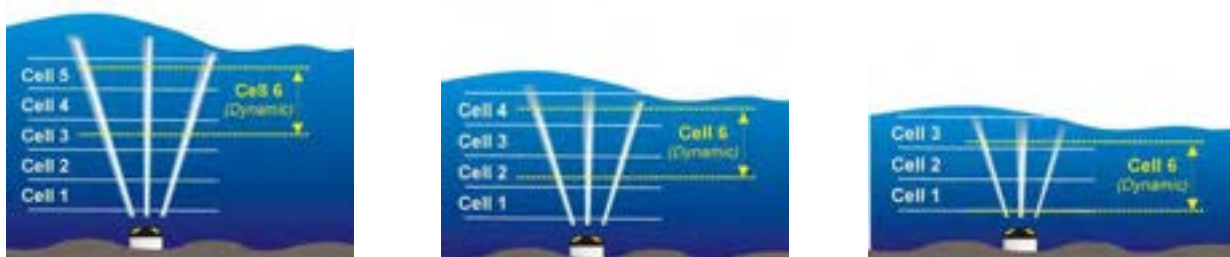
Figura 4. Esempio di utilizzo della funzione multicell, in cui sono utilizzate in maniera combinata la modalità di rilievo con celle fisse e la modalità di cella dinamica. In tale applicazione, la cella dinamica misura le velocità medie in prossimità della superficie.
