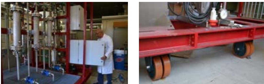
Figura 3. Impianto GESSICA: sezione di upgrading del syngas e dettaglio ruote movimentazione skid
