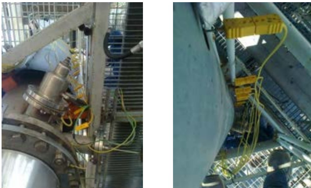
Figura 6. Impianto Piattaforma Pilota: monitoraggio termico del gassificatore
