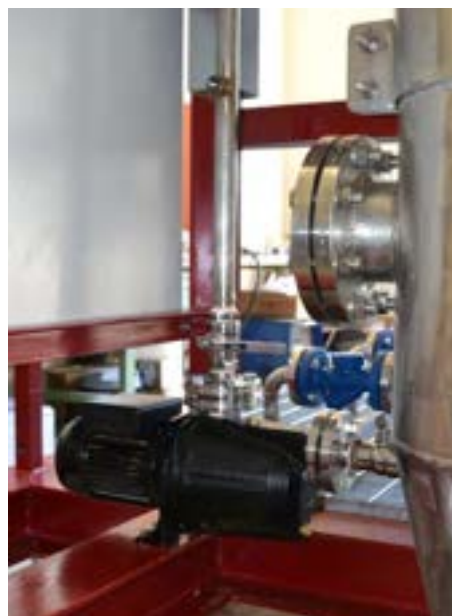
Figura 4. Impianto GESSICA: targa e dettaglio pompa scrubber
