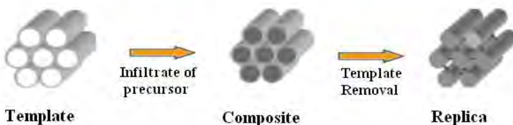
Figura 1. Rappresentazione schematica della procedura di sintesi HT.
