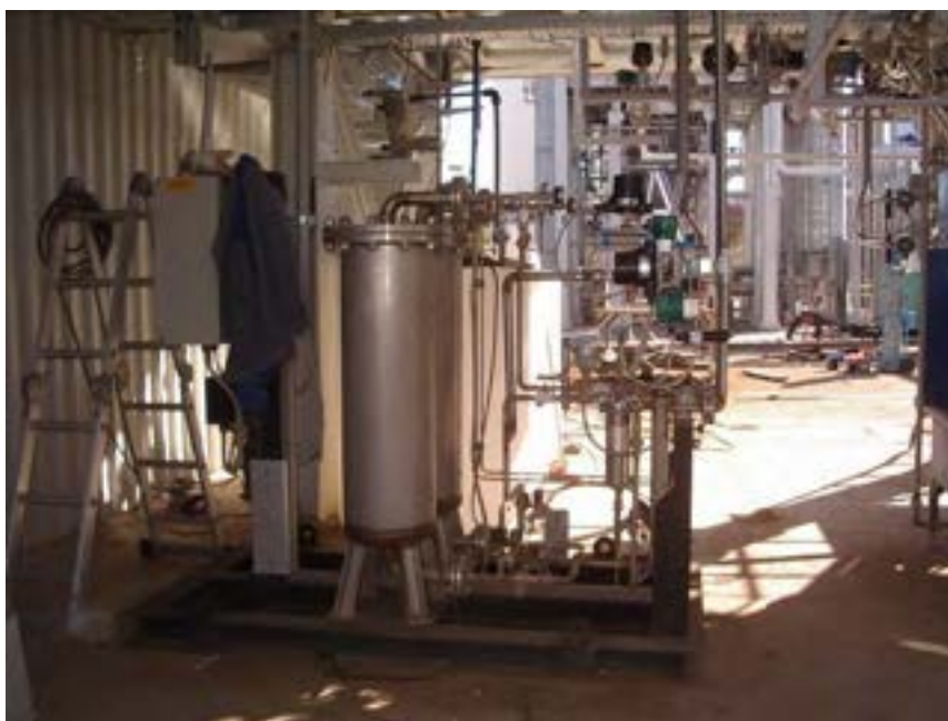
Figura 2.10. Il sistema PSA per la purificazione dell'idrogeno.
