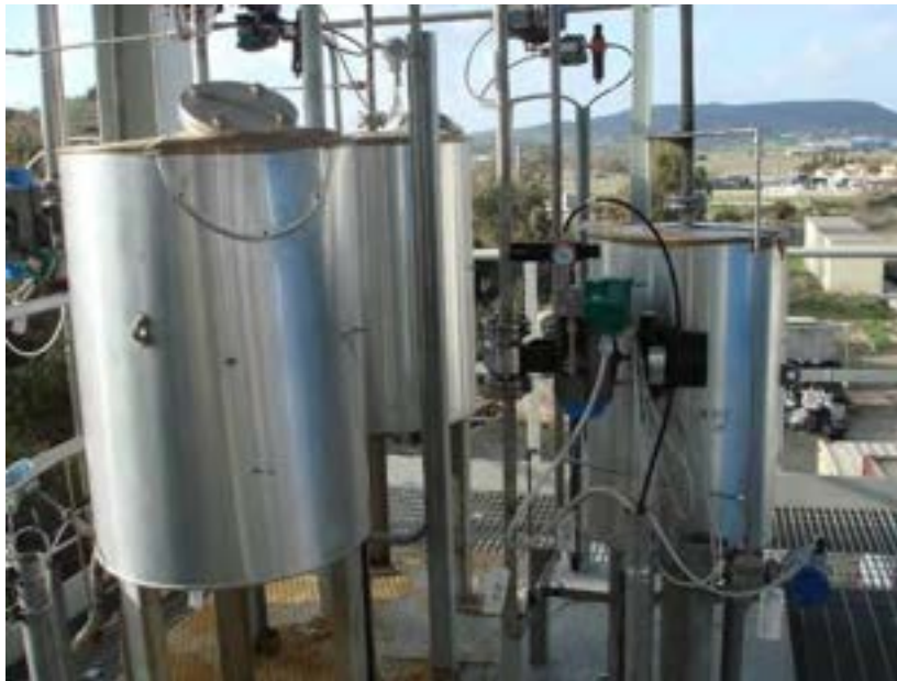
Figura 2.5. Sistema di desolforazione a caldo del syngas.
