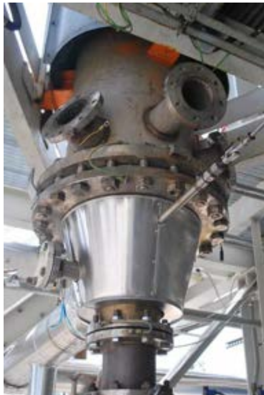
Figura 2.1. La parte inferiore del gassificatore pilota.
