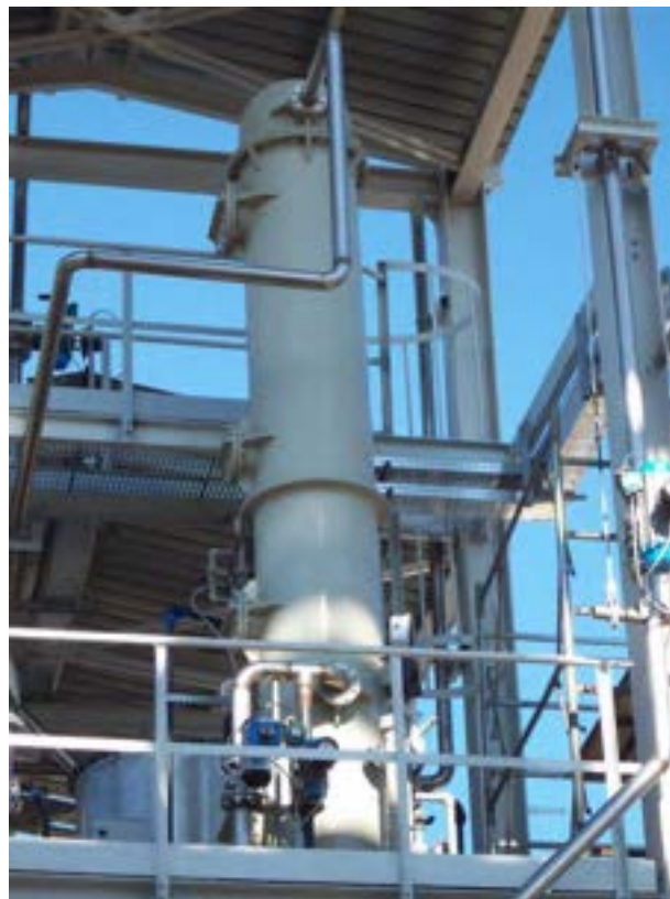
Figura 2.3. Colonna di desolforazione a freddo del syngas.
