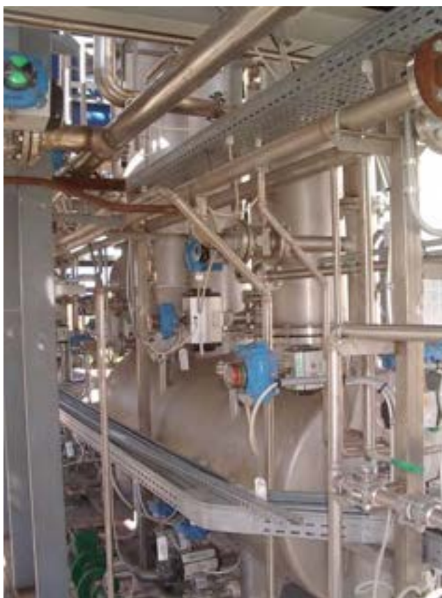
Figura 2.2. Sistema di lavaggio del syngas.
