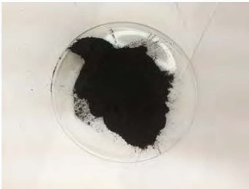
Figura 2. Campione di carbone russo sottoposto a macinazione nel mulino a croce
