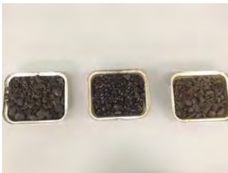
Figura 1. Campioni di carbone Sulcis, russo e ungherese utilizzati per le analisi in laboratorio
