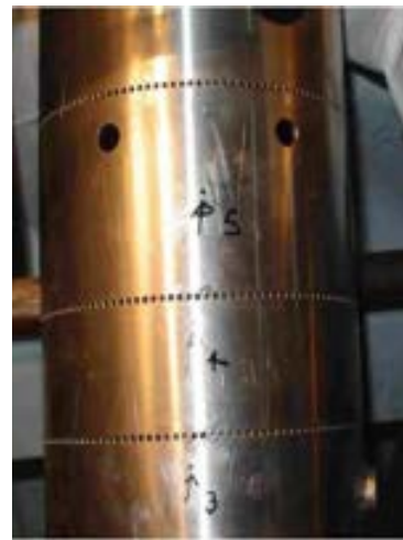
Figura 15 Dettaglio del liner del combustore dual fuel
