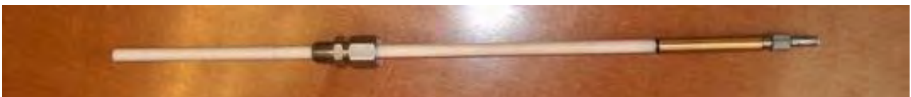
Figura 2. Testa ottica con fibra di zaffiro monocristallino ( \Phi = 2 mm) in un tubo protettivo di allumina ( \Phi \approx 5 mm).
