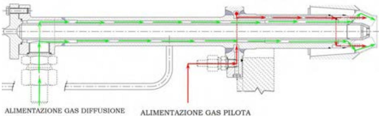
Figura 7. Schema del bruciatore Siemens-Ansaldo V64.3A: particolare dei circuiti preposti all'alimentazione del combustibile gassoso per la fiamma diffusiva (linea verde) e la fiamma pilota (linea rossa).
