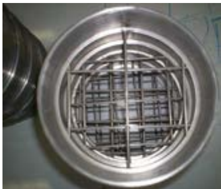
Figura 2. Esempio di setacci utilizzati per l'analisi granulometrica.
