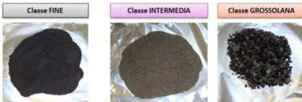
Figura 10. Immagini delle tre classi granulometriche in cui è stato suddiviso il campione di ceneri da ciclone.
