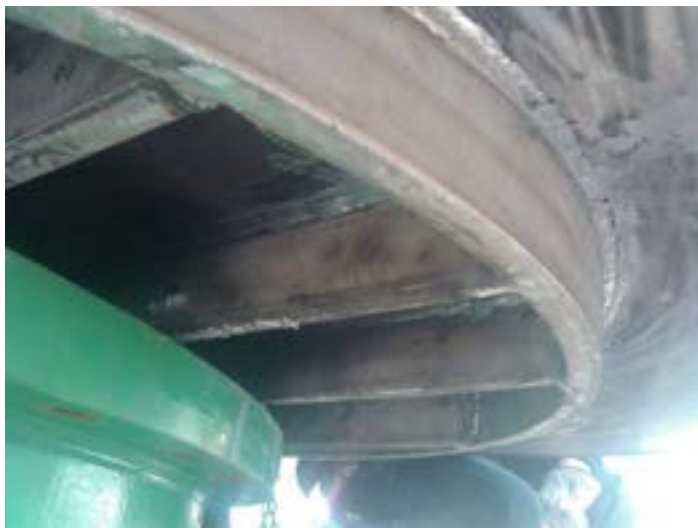
Figura 7 Anello perimetrale di rinforzo del piatto distributore
