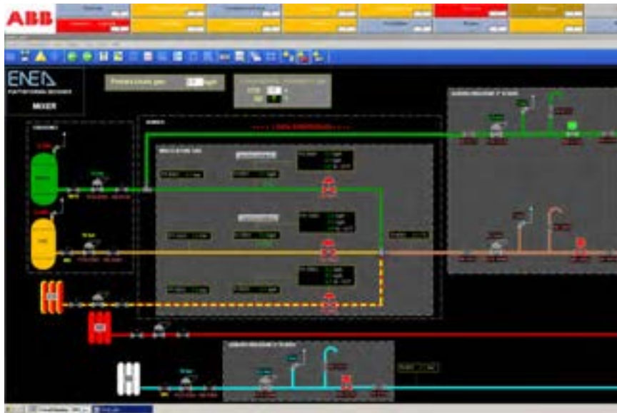
Figura 9 DCS ZECOMIX - Sinottico del MIXER; nuova configurazione (installazione linea CO).
