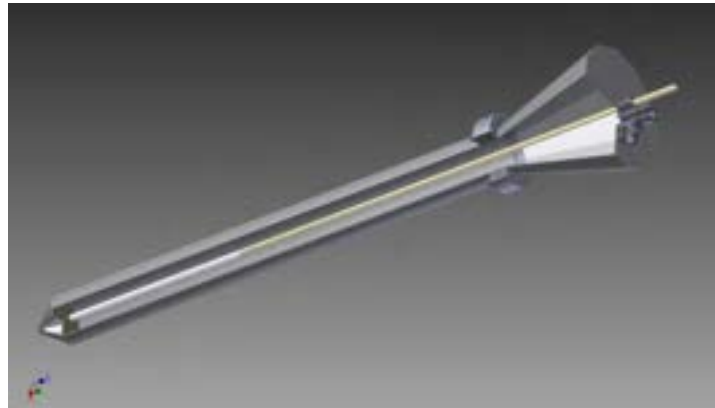
Figura 14: Disegno del reattore per l'apporto di ossigeno attraverso la membrana porosa
