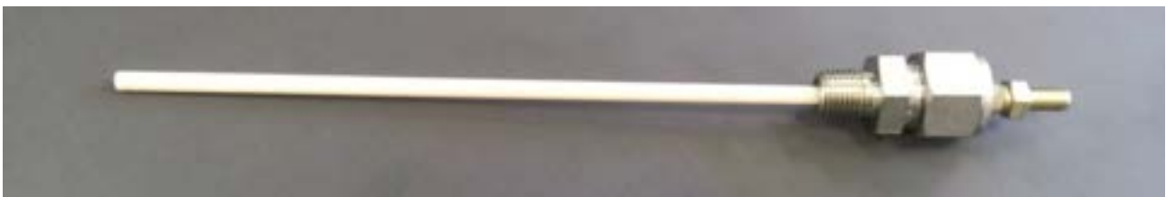
Figura 10. Testa ottica con fibra di zaffiro monocristallino ( \Phi = 2 \text{ mm} ) in un tubo protettivo di allumina ( \Phi \approx 5 \text{ mm} ).
