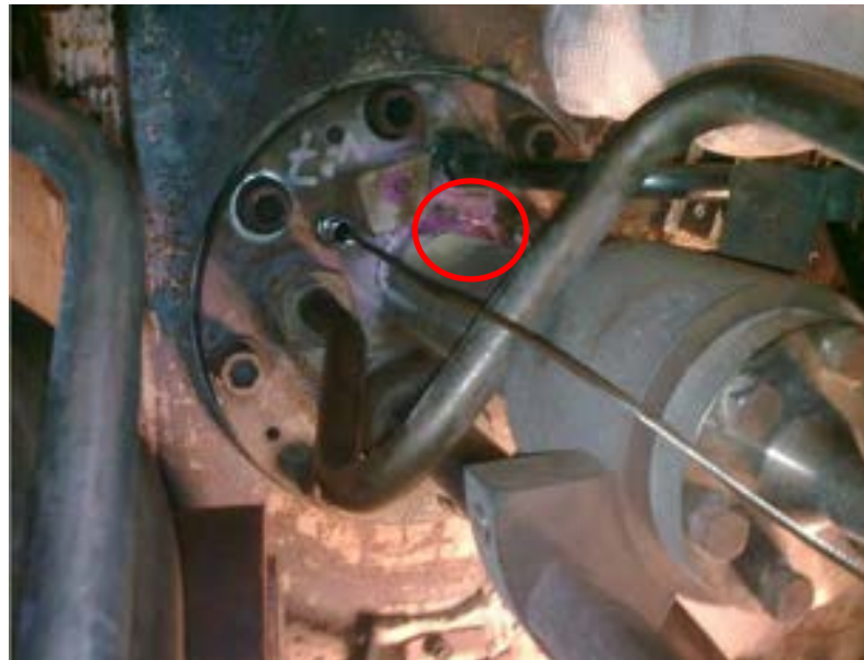
Figura 14. Sonde in zaffiro (a) e test delle sonde (c), da cui è evidente l'isolamento meccanico e termico che viene effettuato (b). Esempio di sensore ottico di pressione installato su una macchina CCGT ( Combined Cycle Gas Turbine ) da 1400 MW (Didcot B) nell'ottobre 2009 (c).
