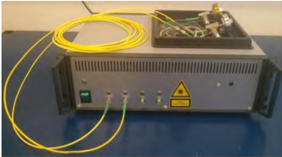
Figura 24. Modelli del sistema di interrogazione (“interrogatore”, “Optical Interrogator Units”) per l’analisi della pressione dinamica (“Dynamic Pressure System”) denominato OxSensis i-Phire 300™ Spectral interrogator per la misura della pressione statica e della temperatura.
