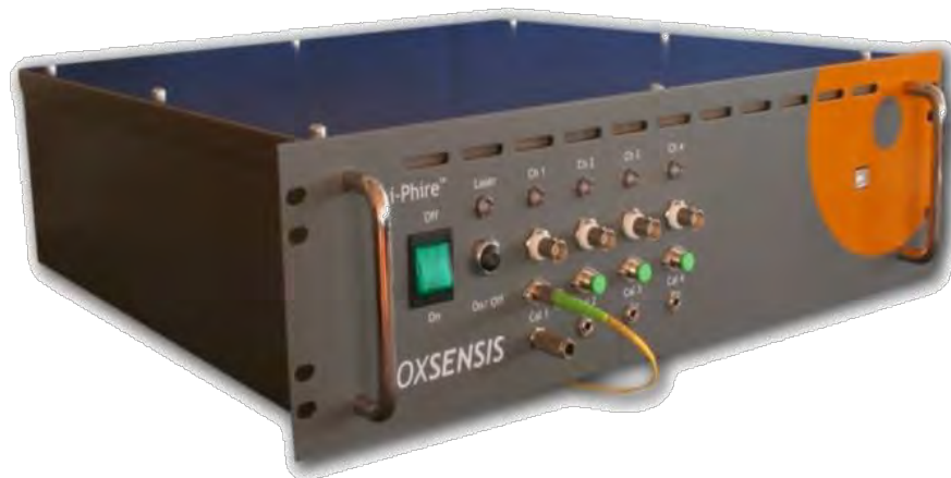
Figura 17. Modelli i-Phire™ 100 Series del sistema di interrogazione (“interrogatore”, “Optical Interrogator Units”) per l’analisi della pressione dinamica (“Dynamic Pressure System”): Oxsensis i-Phire 110™ (a) che ha un solo canale, e Oxsensis i-Phire 120™ (b) che ha quattro canali per la misura ottica della pressione dinamica.
