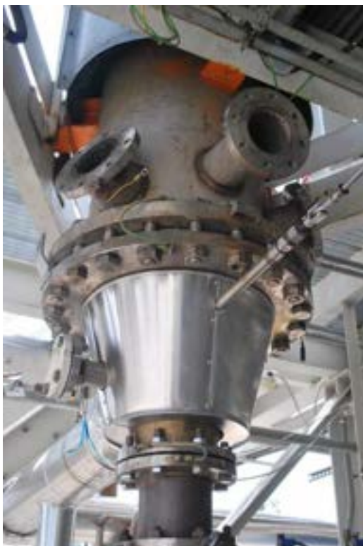
Figura 1. - parte inferiore del gassificatore pilota.
