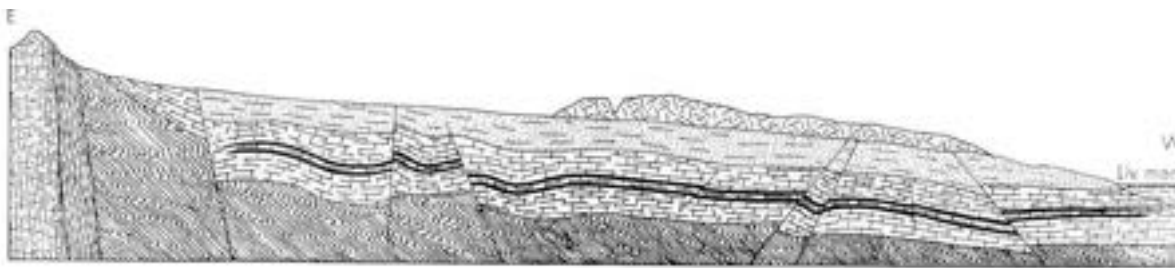
Fig. 3.1 - Ricostruzione schematica della giacitura del giacimento carbonifero del Sulcis (Cavinato, 1964)
