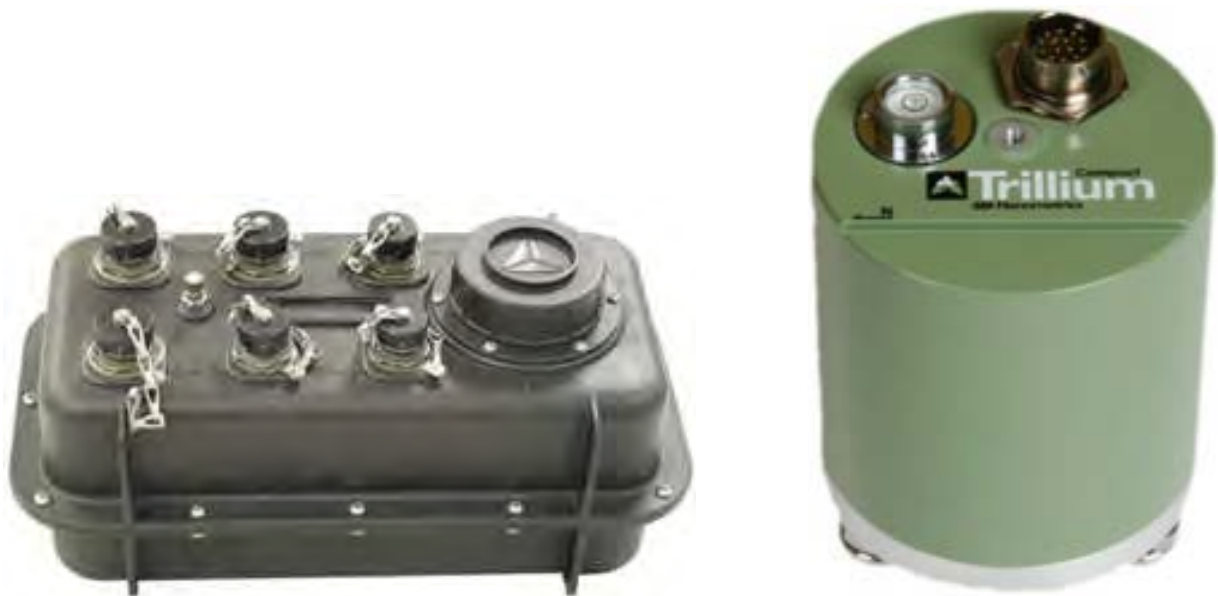
Figura 5.2 – Acquisitore/digitalizzatore 24 bit di tipo Reftek-130_1 (in alto) e velocimetro a banda larga di tipo Nanometrics- Trillium 120 s (in basso). Le immagini dei due oggetti non sono in scala tra loro.
