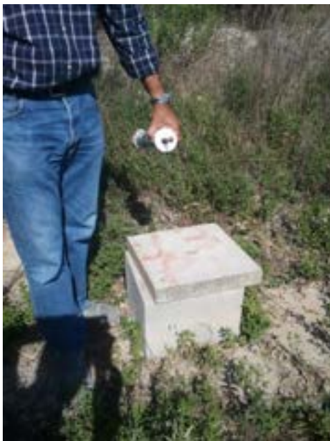
Figura 14. Posizionamento delle sonde nei piezometri
