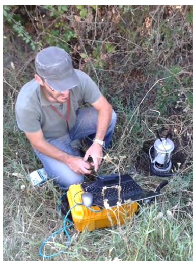
Figura 3 – Attività di monitoraggio della concentrazione e del flusso di CO 2 dal suolo
