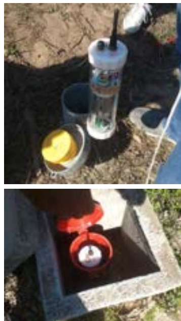
Figura 14. Posizionamento delle sonde nei piezometri
