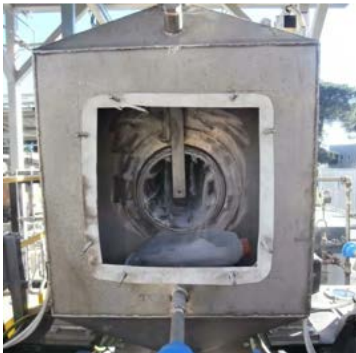
Figura 3 - VALCHIRIA; particolare della camera di calma del pirolizzatore durante prove di taratura.
