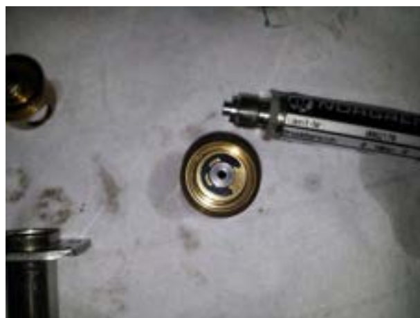
Figura 7. Il corpo valvole di alimentazione della \mu GT durante le fasi di smontaggio e pulizia.
