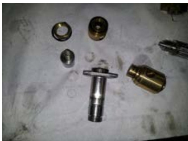
Figura 7. Il corpo valvole di alimentazione della \mu GT durante le fasi di smontaggio e pulizia.
