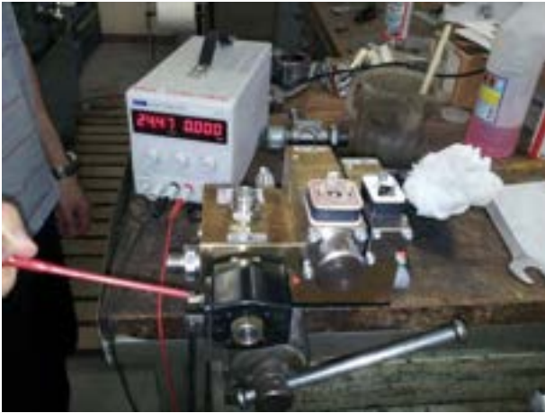
Figura 8. Il corpo valvole revisionato durante il test preliminare al banco (sinistra) e durante l'installazione a bordo macchina (destra).
