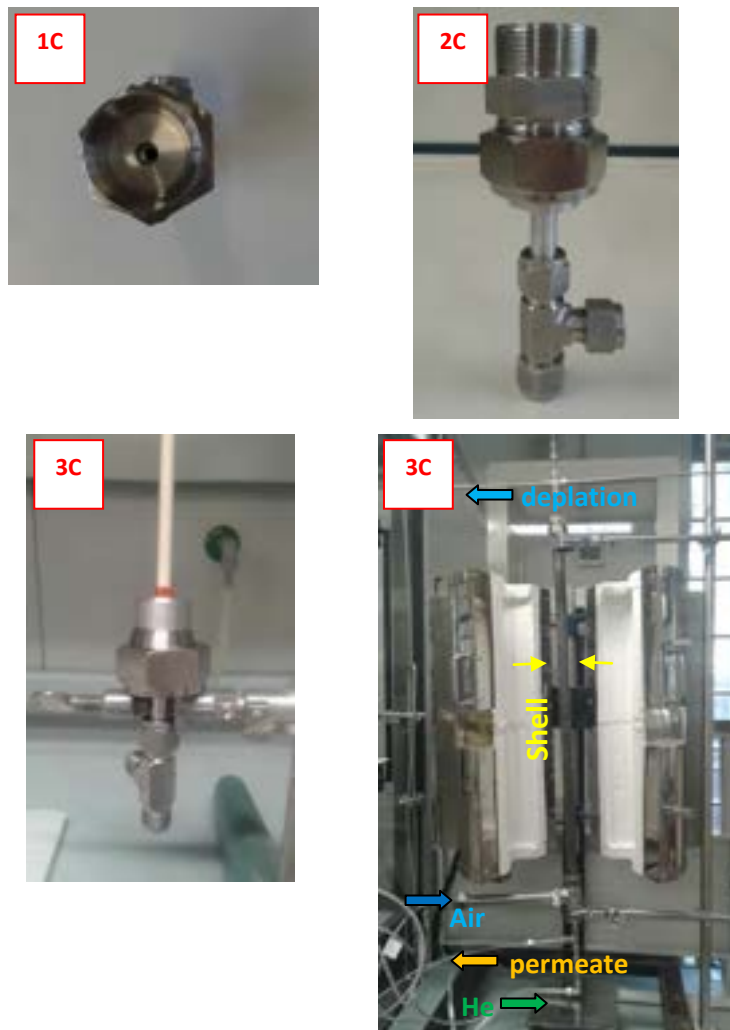
Figura 11. Step C: (1C) sede custom di acciaio inossidabile del tubo di allumina lungo 400 mm e shell esterno (1 pollice diametro esterno e lungo 800 mm), (2C) accoppiamento (1C) con il raccordo a "T" per l'uscita del permeato, (3C) fissaggio con colla siliconica del tubo di allumina (5) in (1C), (4C) assemblaggio finale del modulo membrana con shell esterno.
