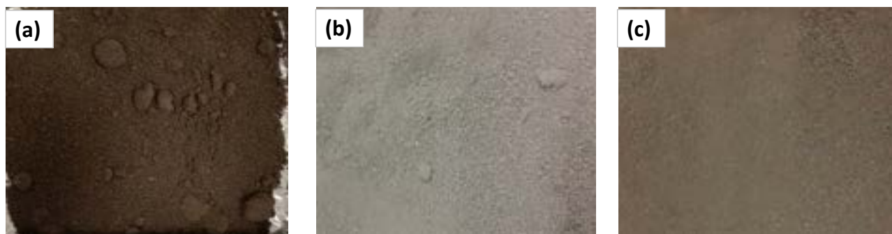
Figura 25. Immagini di campioni di scorie BOF trattate nel reattore a tamburo rotante Valchiria dopo le prove di carbonatazione alle seguenti condizioni: (a) P_{CO_2}=40\% , T= 34\text{ }^{\circ}\text{C} ; (b) P_{CO_2}=46\% , T=37\text{ }^{\circ}\text{C} e (c) P_{CO_2}=40\% e T=50\text{ }^{\circ}\text{C} .
