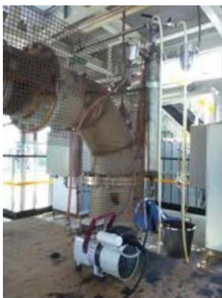
Figura 16, 17. Prese di campionamento DJ001 (uscita gassificatore) e DJ002 (uscita scrubber)
