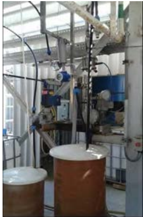
Figura 26, 27. Termocoppia sul solvente in uscita da reattore e Densimetro sul solvente in uscita da reattore
