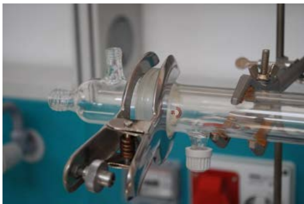
Figura 3.12. Condotto di output gas (Sono identificabili il bocchello per l'inserimento della sonda di controllo - in basso- ed il bocchello per il prelievo -in alto-.
