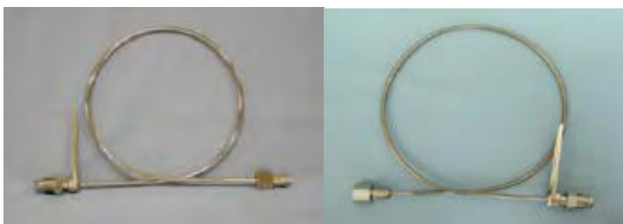
Figura 3.3. Serpentine di collegamento per la bombola contenente H 2 S/N 2 (foto a sinistra) e per la bombola contenente N 2 (a destra)
