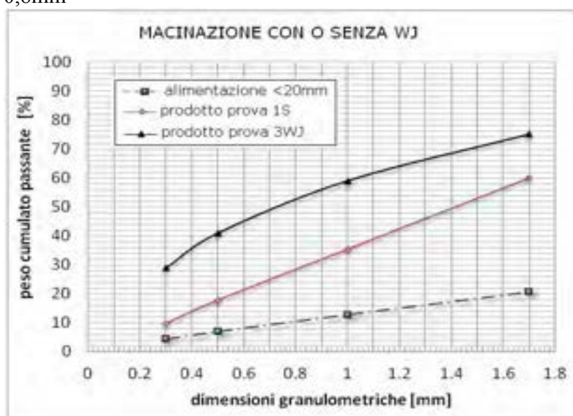
Figura 7.10.4-Confronto tra macinazione a secco e macinazione water jet. Diametro ugello 0,8mm
