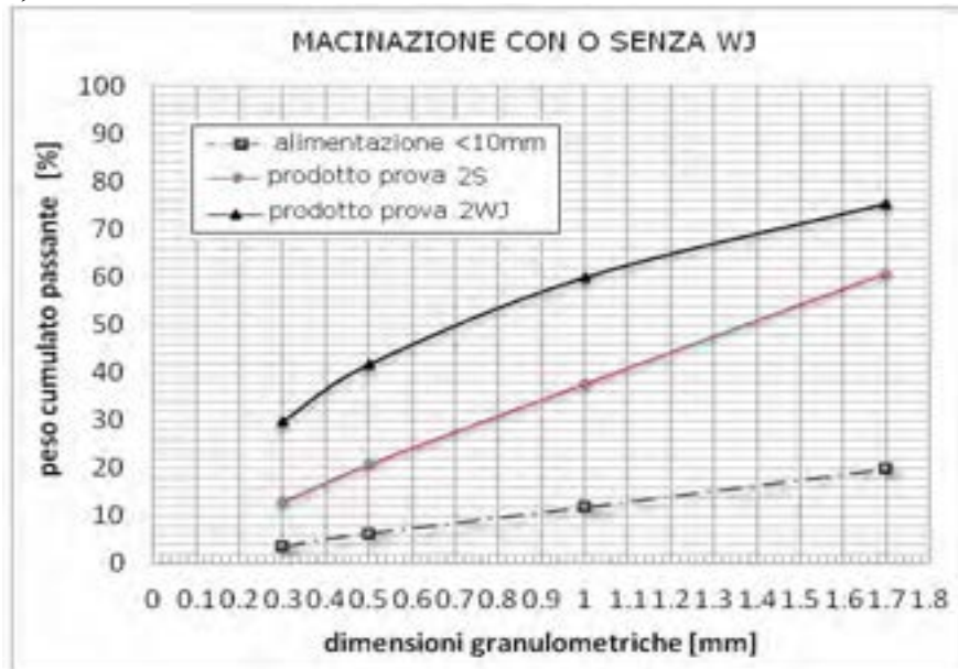
Figura 7.10.5-Confronto tra macinazione a secco e macinazione water jet. Diametro ugello 0,8mm
