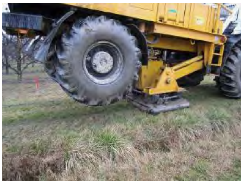
Figura 23: Piastra vibrante appoggiata al suolo per energizzazione
