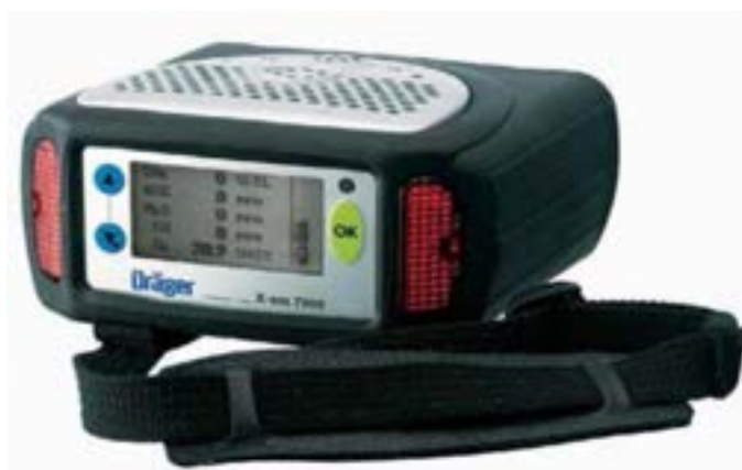
Figura 15: Dispositivo con sensori all'infrarosso per le misure in situ di CO 2 , CH 4 , H 2 S, H 2 e O 2 .
