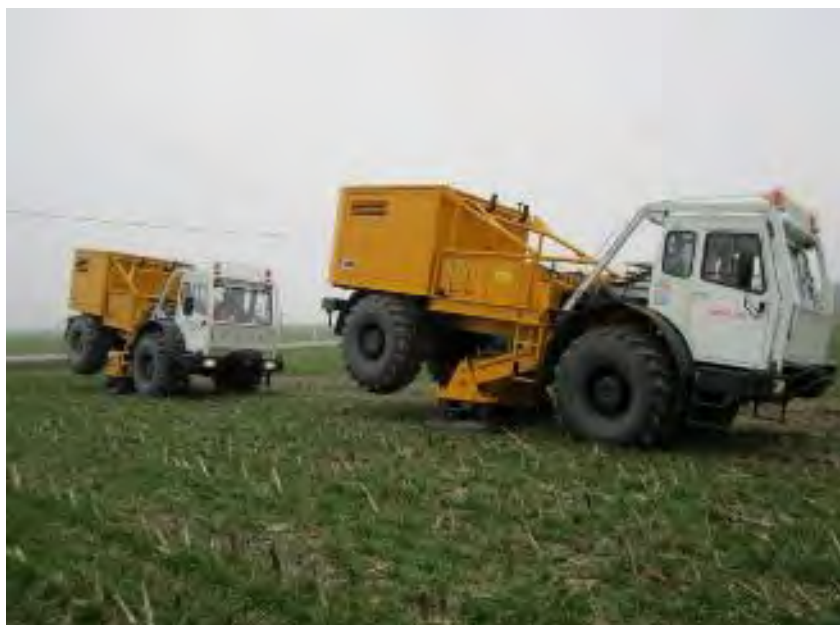
Figura 22: Esempio di mezzo utilizzato per acquisizione sismica Vibroseis
