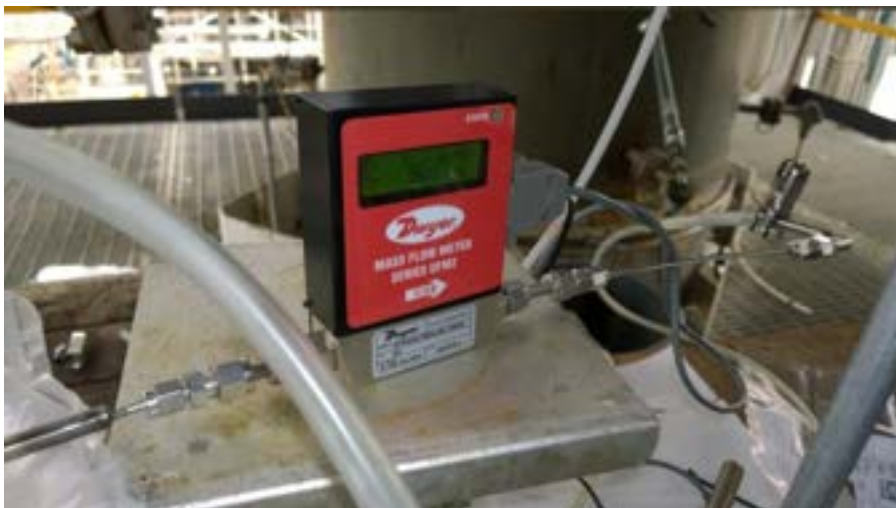
Figura 13. Allestimento del contatore di gas Dwyer, Serie GFM2, nel campionamento del giorno 09 settembre 2015.
