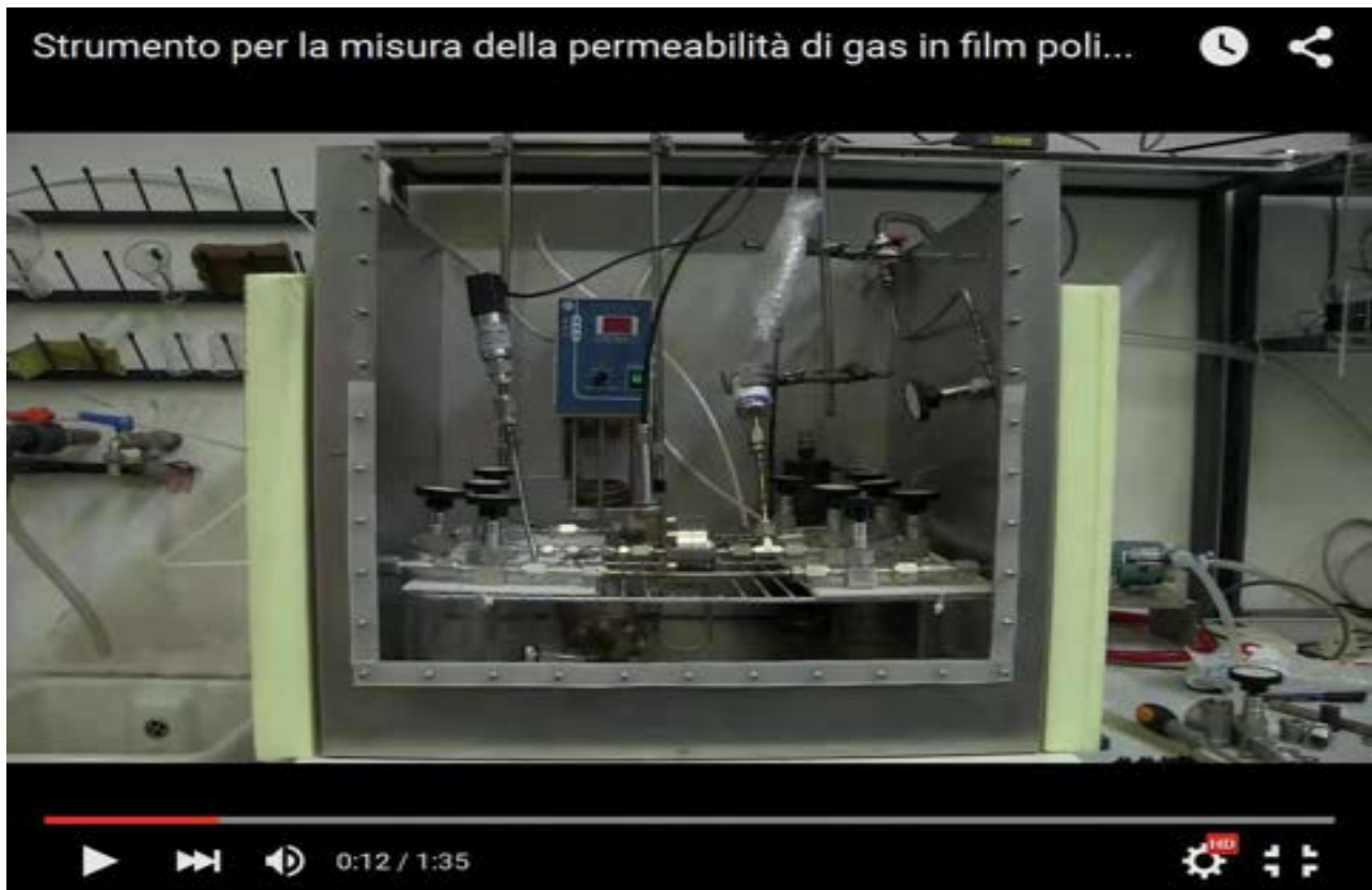
Figura 6: (a) Schema e (b) Video dell'impianto di permeazione a umido presso il DICAM
