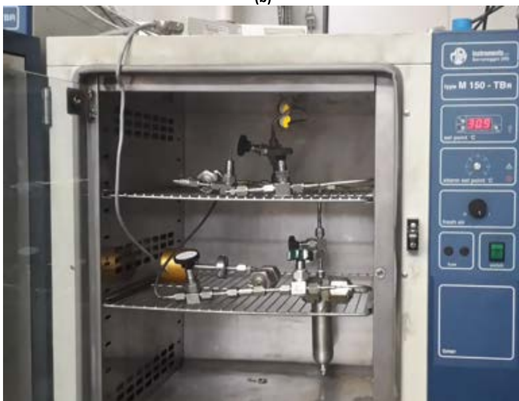
Figura 5: (a) schema e (b) foto di impianto pressure decay per la solubilità di gas ad alta pressione
