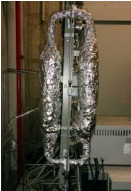
Figura 2.7. Trappole per ferro-carbonili
