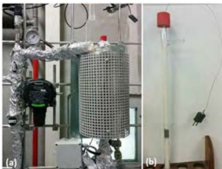
Figura 2.8. Zona di reazione (a), reattore caricato (b)
