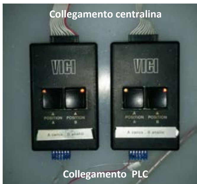
Figura 2.16. Telecomandi delle valvole con doppio collegamento
