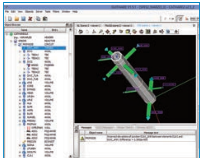
Particolare del modello 3D dell'annular downcomer di SPES2 simulato con CATHARE
