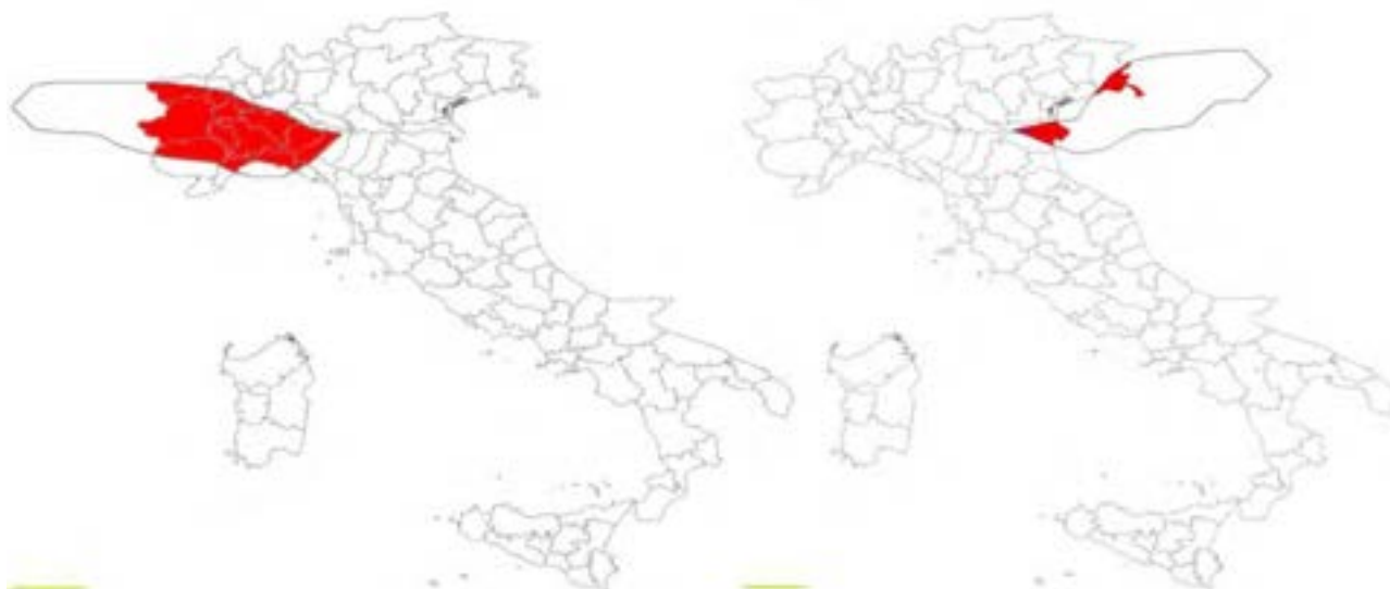
Figura 38 - Esempio di risultati ottenuti con il codice ARIES. Curva di isodose (10 mSv alla tiroide nei bambini - 48 h). Ipotesi di incidente alla Centrale di St. Alban (scenario a sinistra) e di Krško (scenario a destra). (28 p. 9 e 10, Allegato 4)
