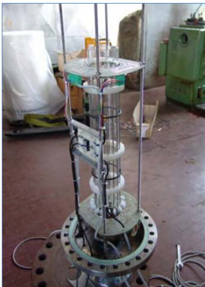
Figura 5 – Sonda capacitiva per misura di grado di vuoto
