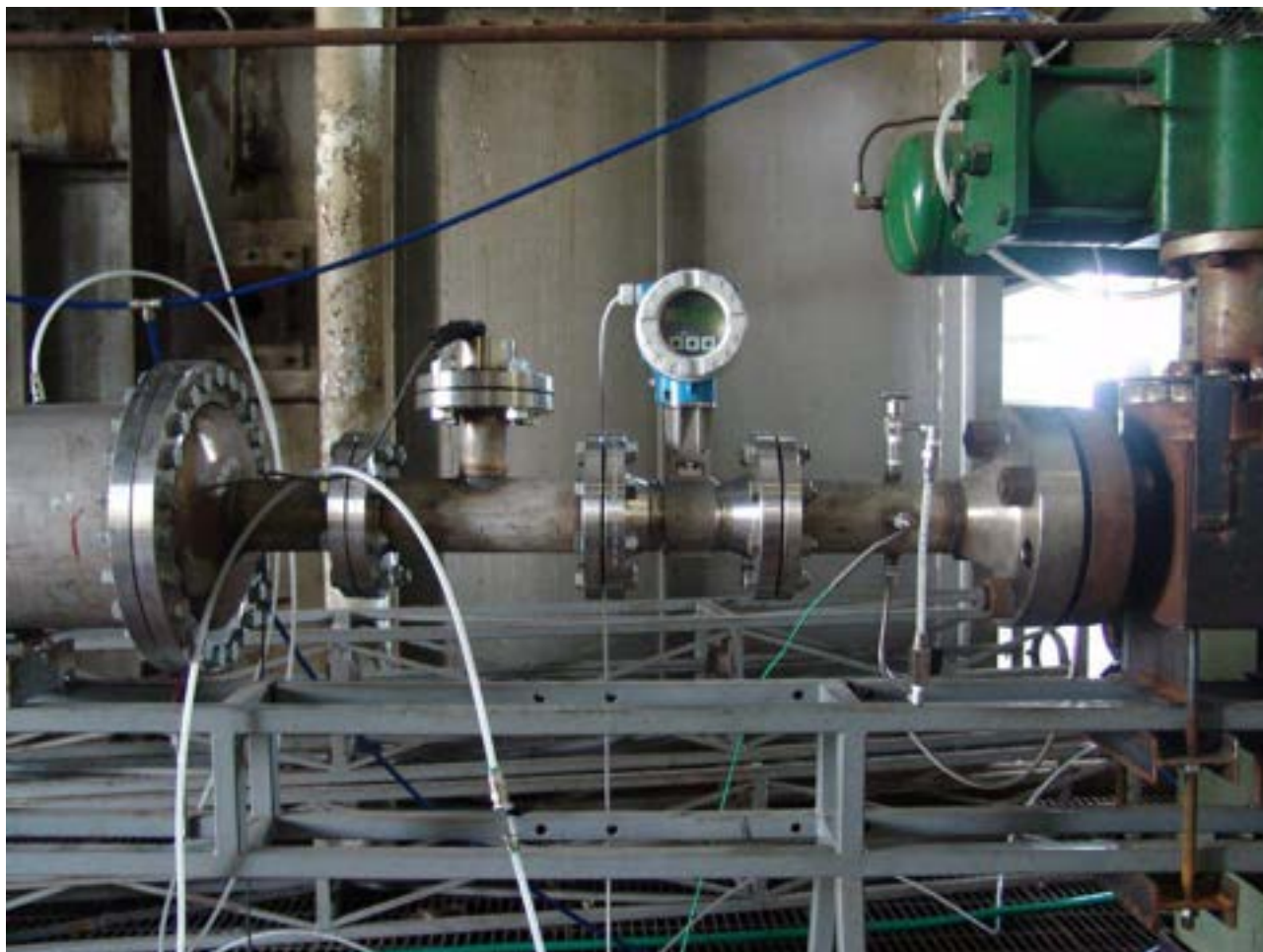
Figura 4: Installazione drag disk e vortex nella sezione di prova
