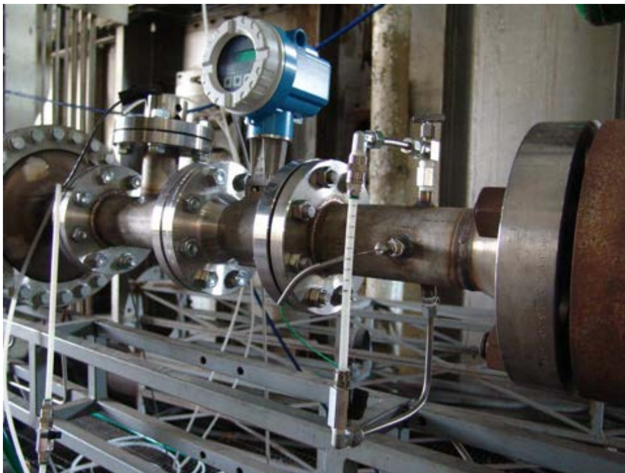
Figura 9: Indicatore graduato di livello per prove statiche
