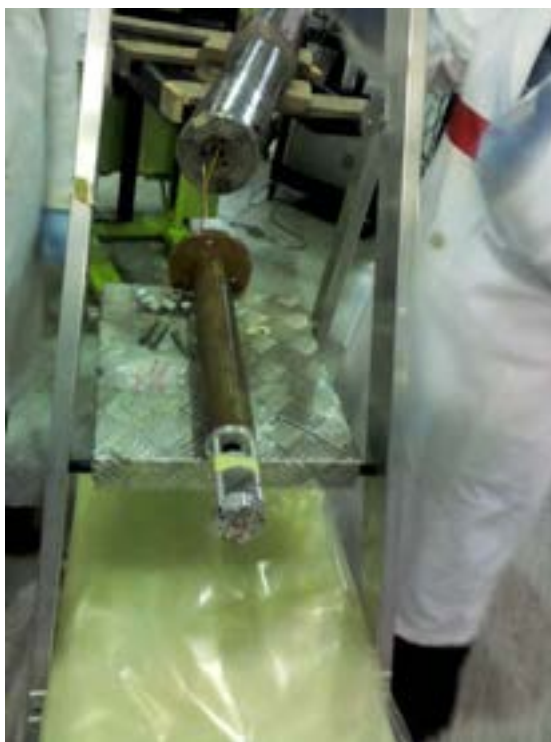
Figura 4: Il porta campioni ancorato al cilindro in rame per la chiusura del canale del reattore
