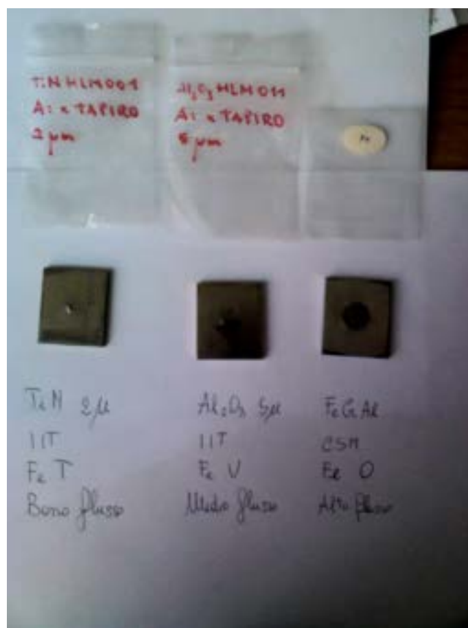
Fig. 10: I provini realizzati per l'irraggiamento
