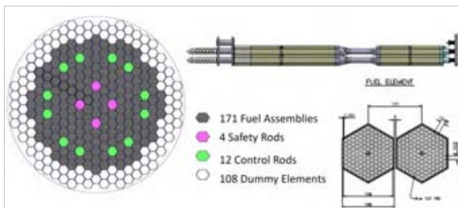
Figura 39 - Schematizzazione del nocciolo di ALFRED e dell'elemento di combustibile.
