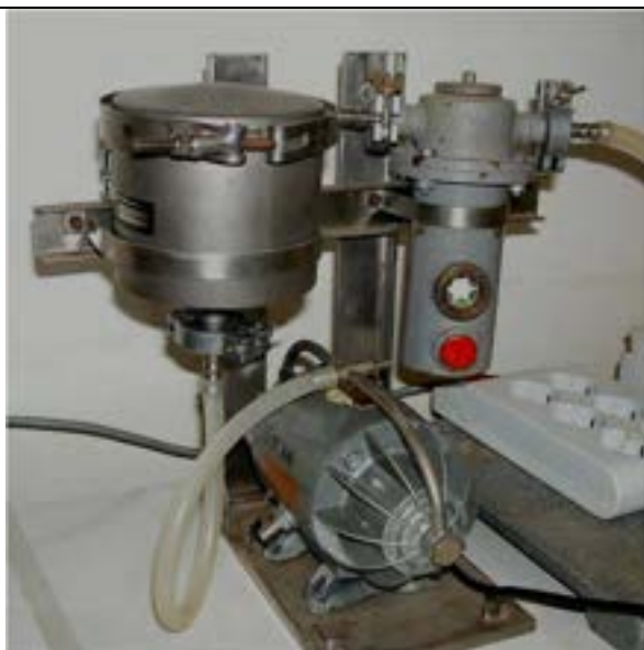
Pompa per insufflaggio d'aria con relativi filtri
