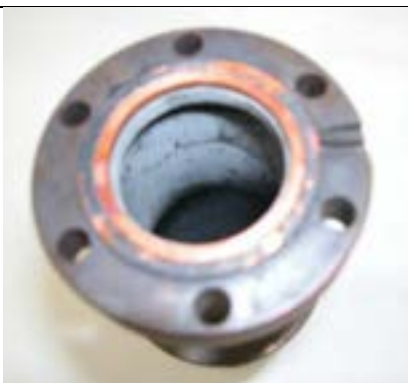
CsCl condensato all'interno del reattore
