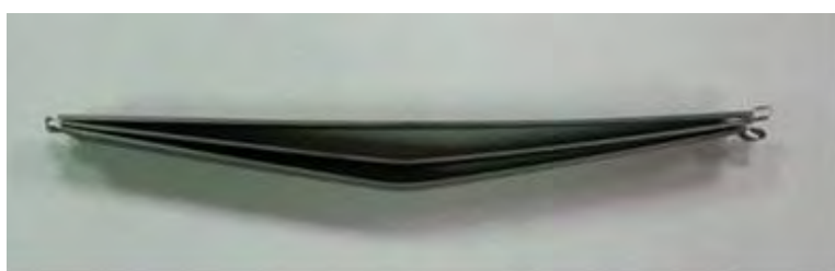
Figura 8.15 - Provini FeCrAl prima della flessione e dopo la flessione a due frecce diverse.
