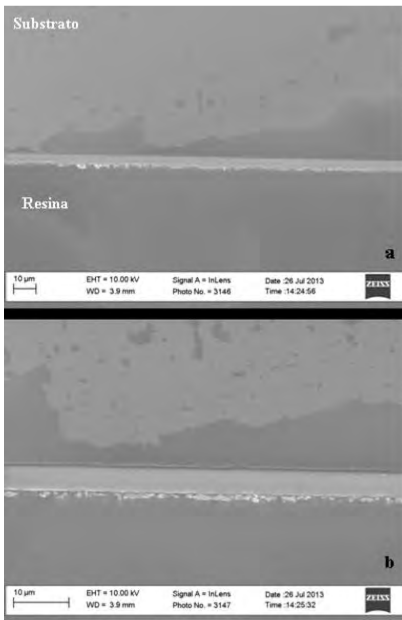
Figura 9.9 - Micrografie SEM della sezione del rivestimento 116/10 a) 2kx, b) 5kx
