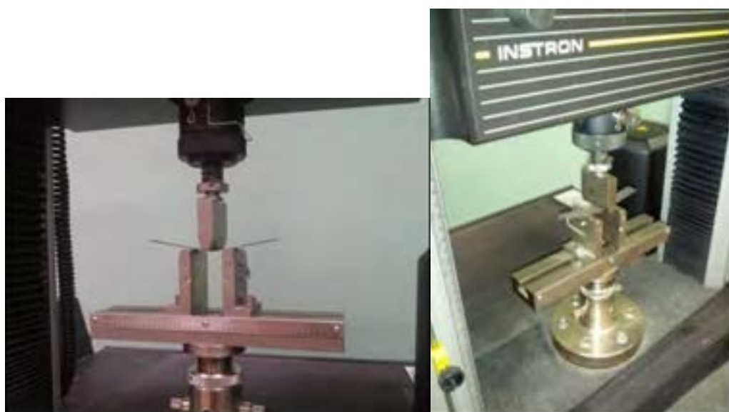
Figura 7.1 - Set-up sperimentale della prova di bending a tre punti.
