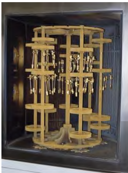
Figura 4.7 – Vista generale della giostra con i campioni all'interno della camera di deposizione (campagna di deposizione TiN precedente Piano Annuale di Realizzazione).
