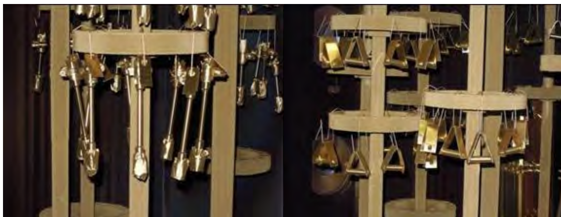
Figura 4.6 – Dettaglio afferraggio provini campagna di deposizione TiN precedente Piano Annuale di Realizzazione.
