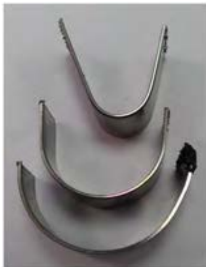
Figura 20. Foto dei campioni dopo la prova di piega. Il rivestimento è presente sull'estradosso delle lamine piegate.
