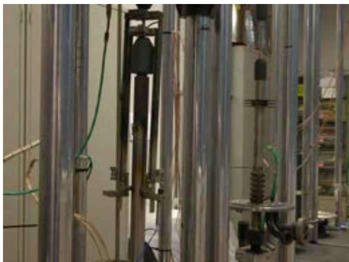
Fig. 17–Sistema standard per la rilevazione delle deformazioni del campione
