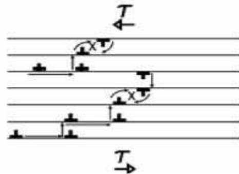
Fig. 2 – Movimento di dislocazioni a spigolo ad alta temperatura; le dislocazioni si muovono attraverso una sequenza di scorrimenti (freccie orizzontali) e salti (freccie verticali), fino ad incontrare dislocazioni di segno opposto annullandosi.
