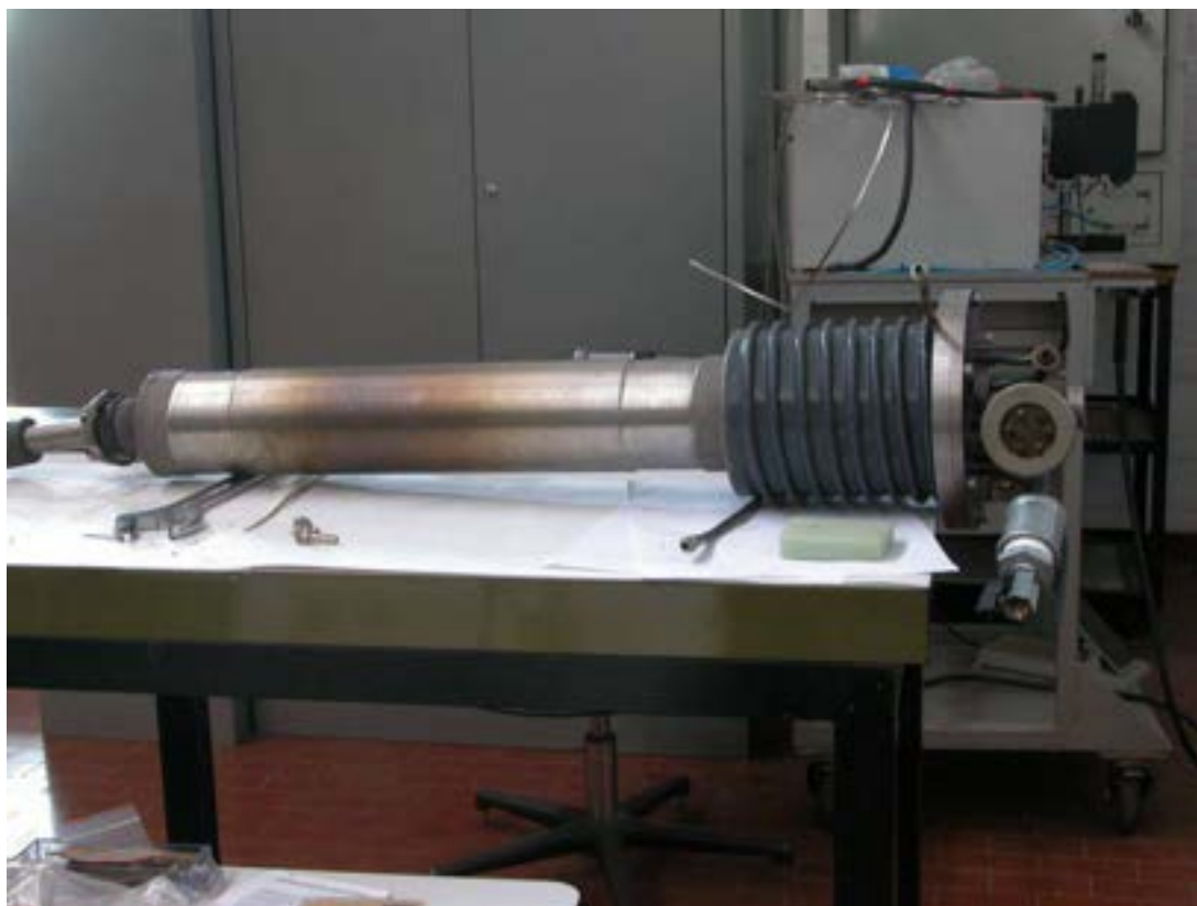
Fig. 24–Termo-camera da vuoto montata a banco
