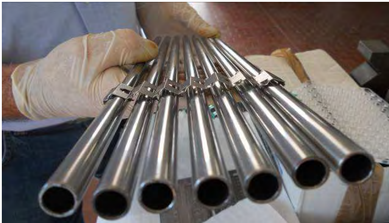
Fig. 58 – Prima fila di barrette bloccate dalle componenti di griglia 1 e 2
