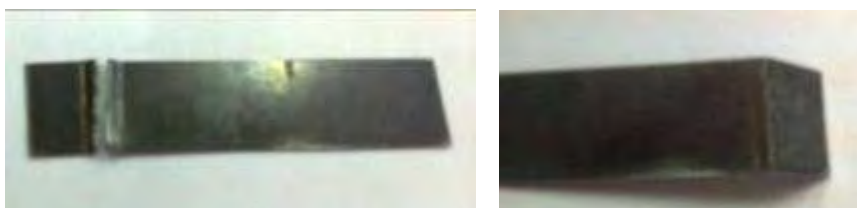
Fig. 21 - A sinistra piega su materiale poco incrudito, a destra piega su materiale molto incrudito
