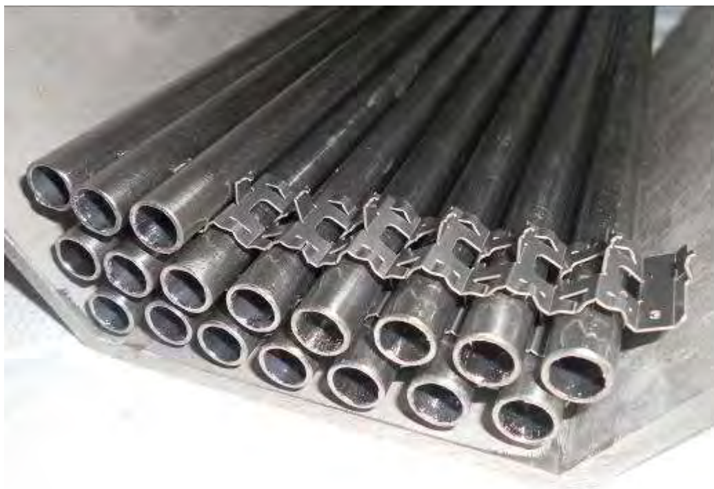
Fig. 62 – Vista del fascio parziale che è bloccato dalle componenti di griglia agganciate fra loro
