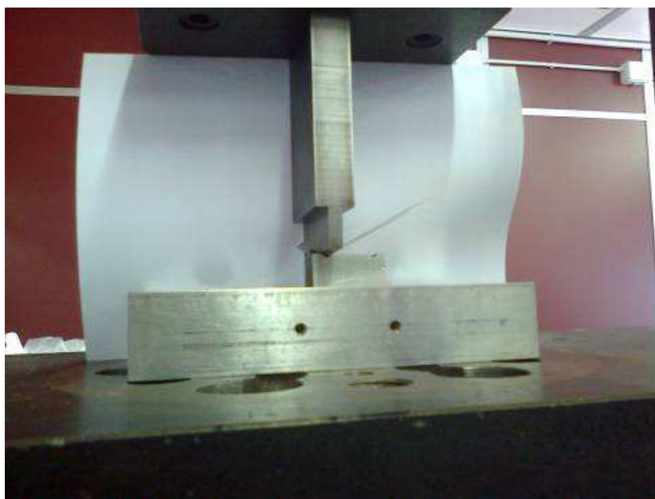
Fig. 19 – Punzone e matrice realizzati in FN, montati sulla Instron: prima prova di piega per testare l'attrezzatura (fase di piegatura)
