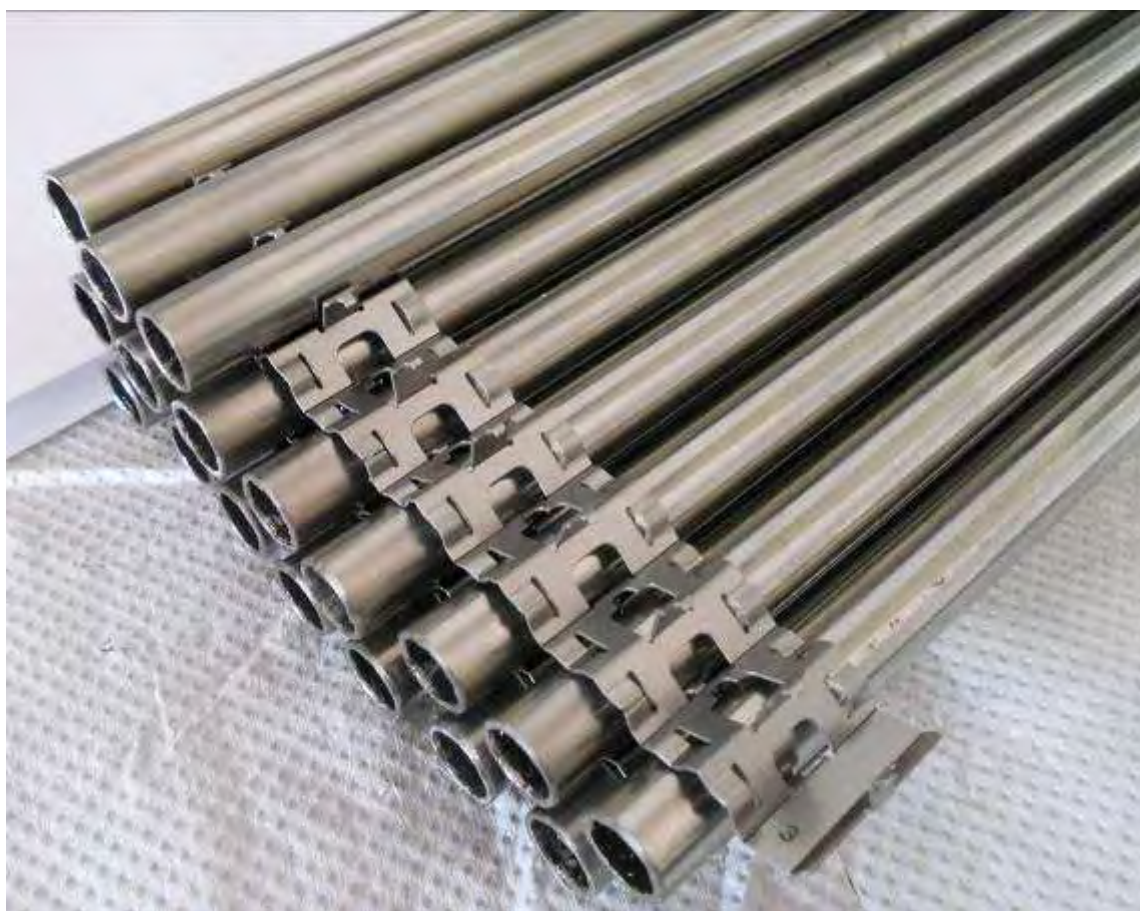
Fig. 61 – Fase di montaggio con inserimento terza fila di barrette
