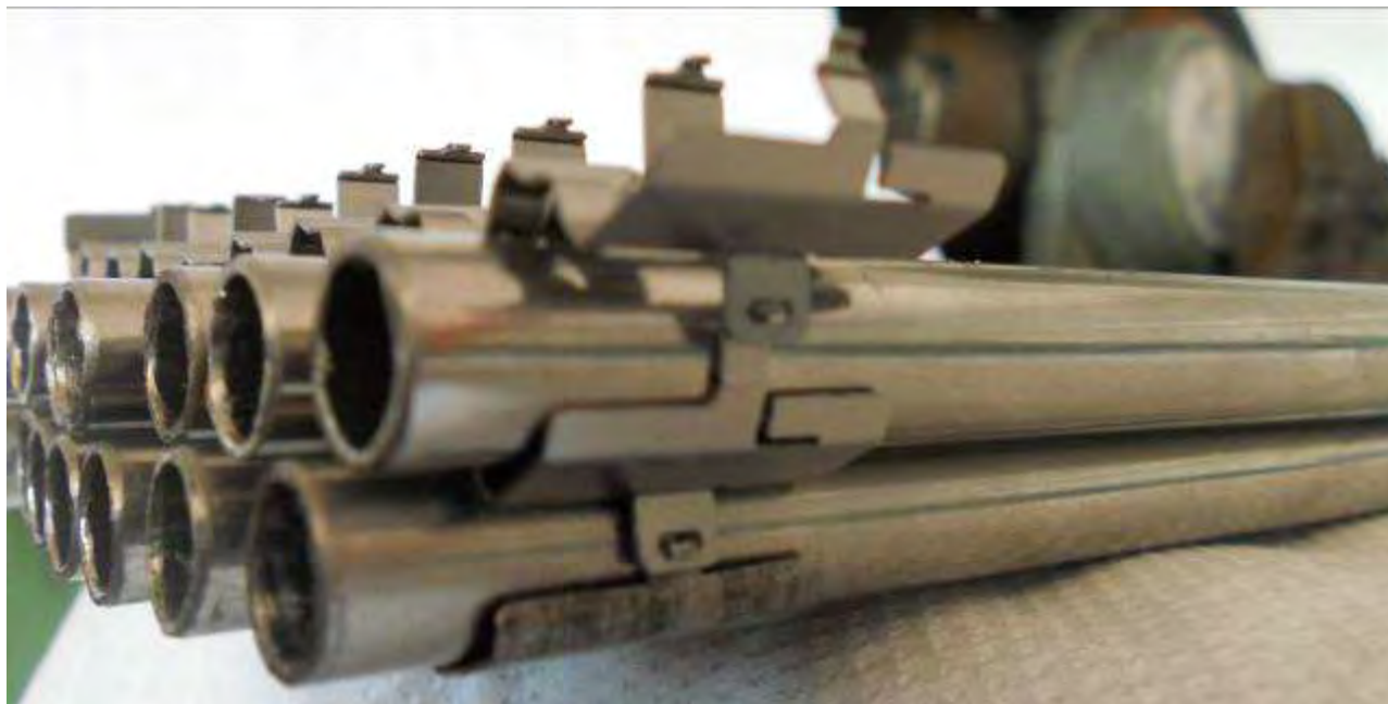
Fig. 60 – Particolare dell’aggancio fra le componenti di griglia
