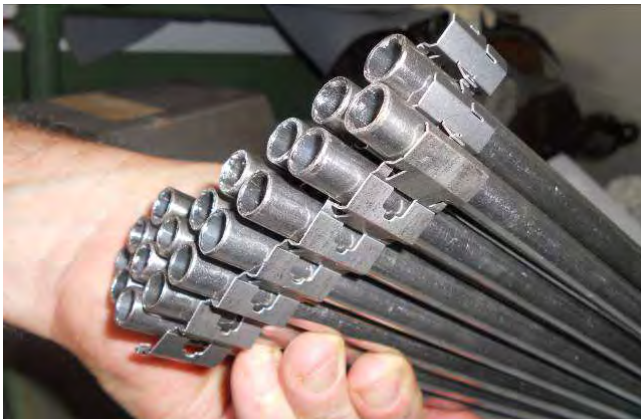
Fig. 62 – Vista del fascio parziale che è bloccato dalle componenti di griglia agganciate fra loro
