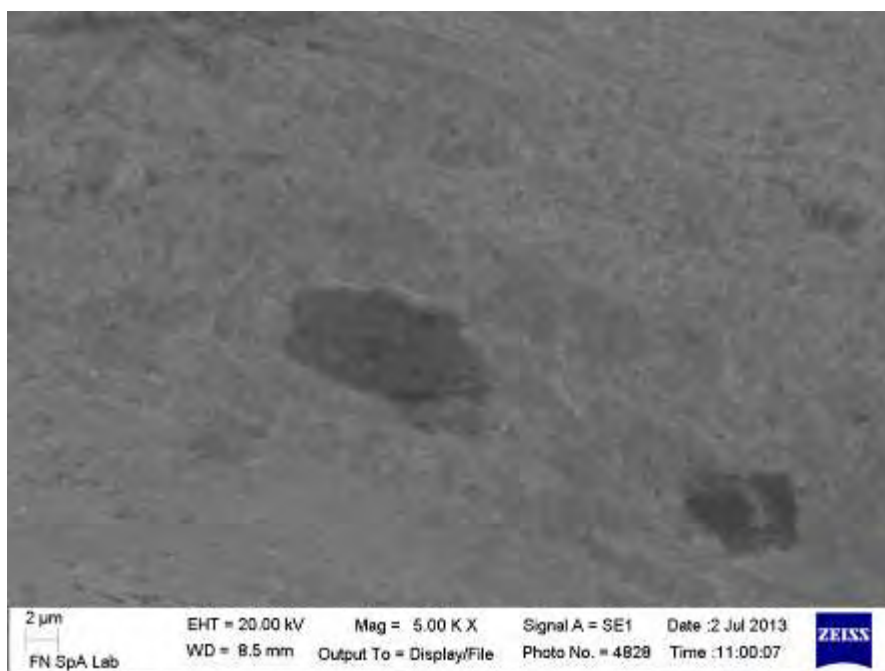
Fig. 27 – Immagine al SEM di lamina incrudita al 50% - superficie a 5000 X
