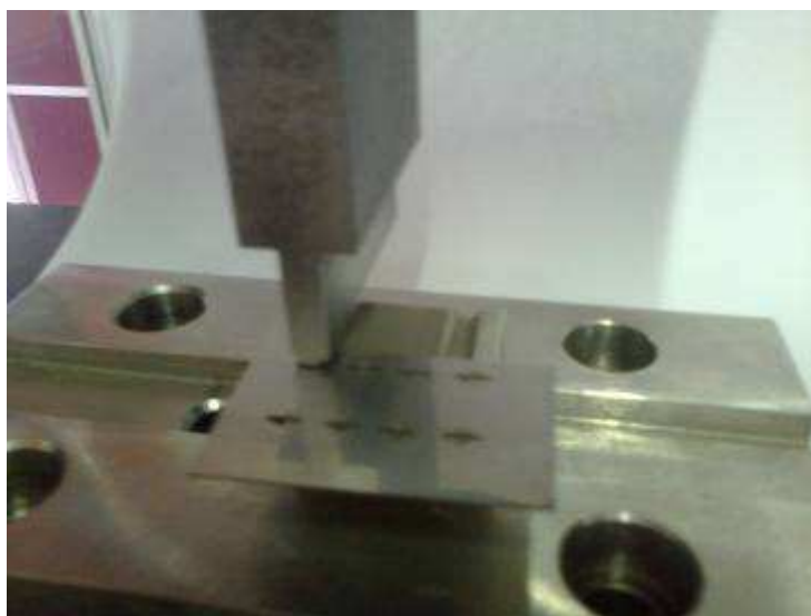
Fig. 23 – Prova di piega su lamina con asole, campione dopo piega vicino ad asole a simulare la griglia
