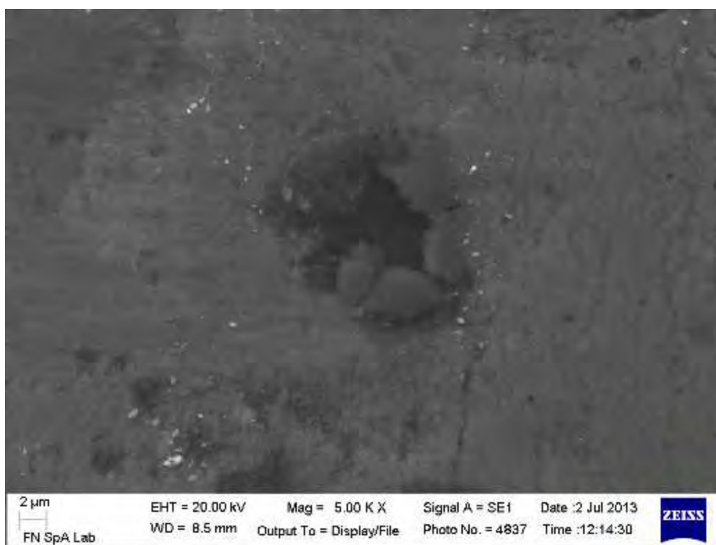
Fig. 33 – Immagine al SEM della lamina incrudita al 75% - superficie a 500 X
