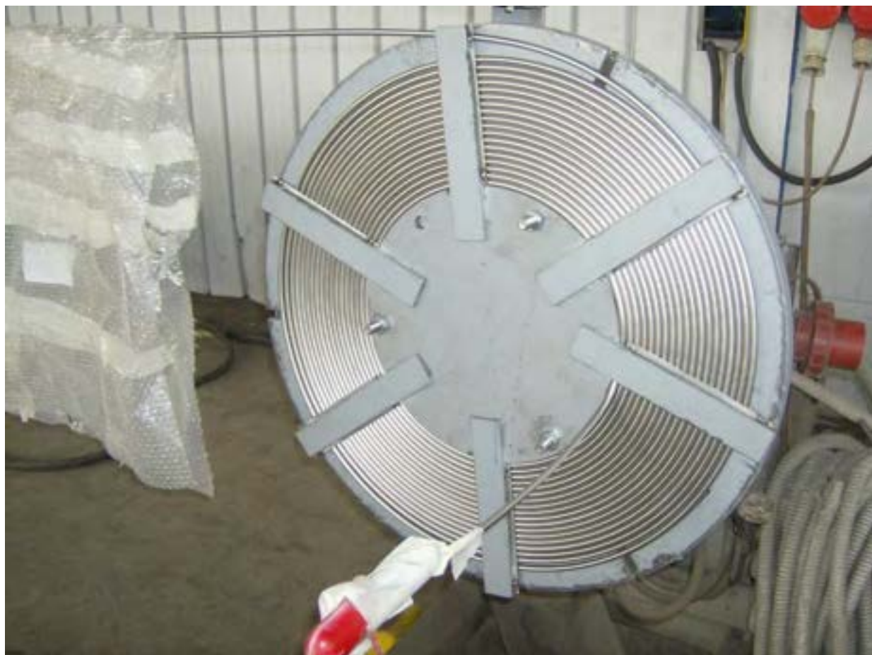
Figura 3. Spiralatura dei tubi nell'officina Tecnomec di Taranto
