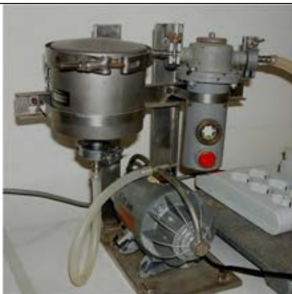
Pompa per insufflaggio d'aria con relativi filtri
