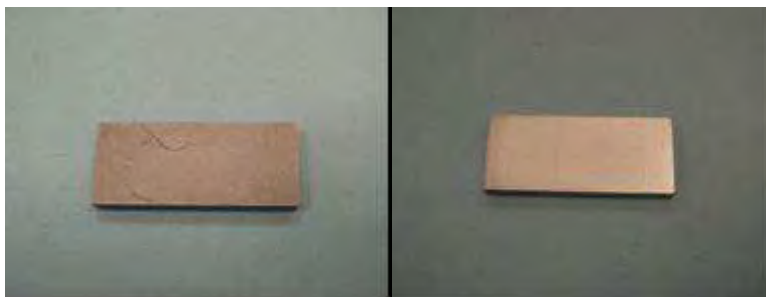
Figura 9 – Aspetto dei provini prima (sinistra) e dopo (destra) il trattamento di alluminizzazione
