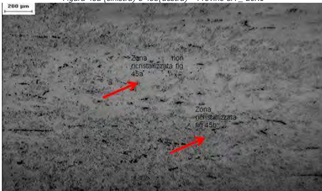
Figura 45 – Analisi grano provino 5B(processo 2) immagini MO 5X08
