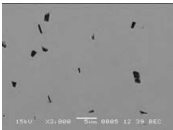
Figura 5 – Analisi SEM – EDS sezione metallografica campione acciaio 9%Cr dopo trattamento di alluminizzazione: dettaglio precipitati inner layer
