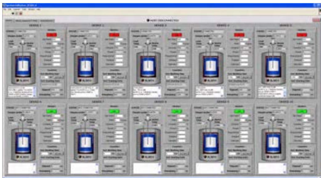
Fig.2: Software ENEA per il controllo e il monitoraggio dei parametri e per l'acquisizione dati durante le prove di corrosione nelle capsule sperimentali.
