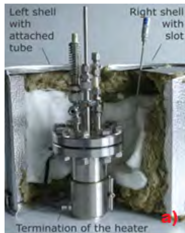
Fig.1a,b: Immagini da [1] che mostrano a) una capsula sperimentale KIT senza i componenti isolanti e b) sensore KIT per ossigeno per prove di corrosione in piombo liquido ad alto e basso contenuto di ossigeno.
