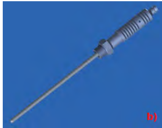
Fig.1a,b: Immagini da [1] che mostrano a) una capsula sperimentale KIT senza i componenti isolanti e b) sensore KIT per ossigeno per prove di corrosione in piombo liquido ad alto e basso contenuto di ossigeno.
