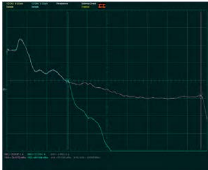
Figura 33: segnale in aria e con 130.5 cm di liquido
