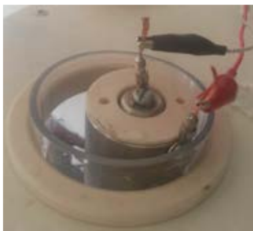
Figura 32 particolare delle connessioni al sensore coassiale
