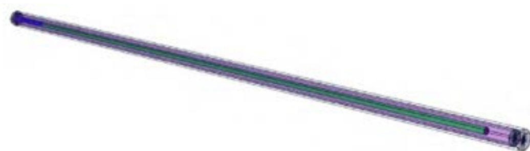
Figura 25 - Visualizzazione 3D del modello del SPND Thermocoax ricostruito in MCNPX.
