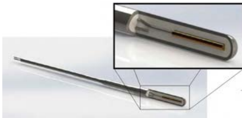
Figura 22 - Disegno concettuale del rivelatore SPND Thermocoax standard.
