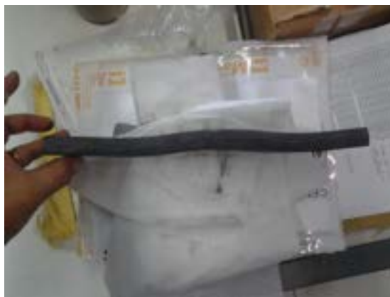
Fig. 1. “Waving” della lamiera DS4 dopo laminazione a freddo
