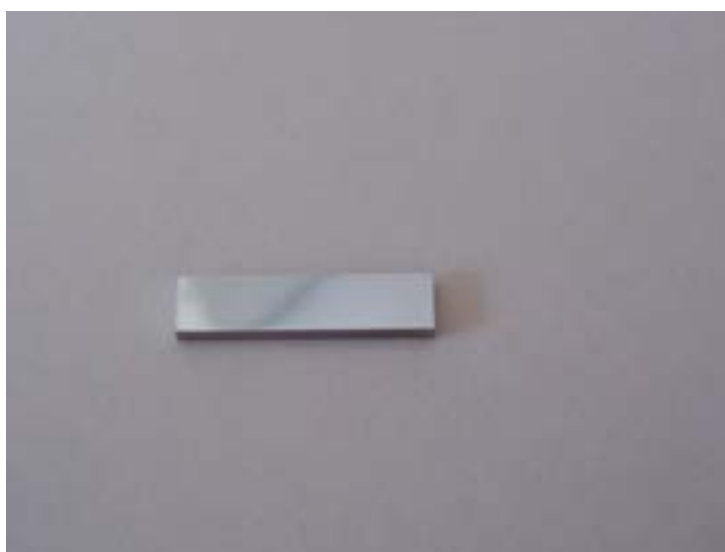
Fig. 19. Campione per Ion Irradiation (superficie lucidata a specchio)
